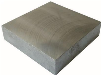
Рис. 1. Тестовая деталь для измерения отклонения от плоскостности
